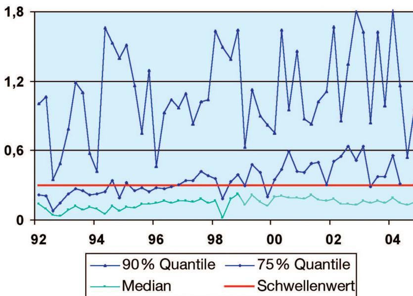
**Orthophosphat im Grundwasser des Südlichen Eferdinger Beckens (Auswertung der WGEV Messstellen. Median: 50 % der Werte sind höher, 50 % niedriger. 75 % Quantile: 25 % der Werte sind höher, 75 % niedriger)**
