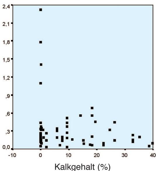
**Mit steigendem Kalkgehalt der Böden nimmt die Wahrscheinlichkeit hoher Phosphatgehalte im Grundwasser ab.**
