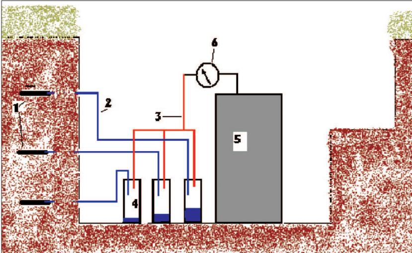
**Schema einer Sauganlage mit drei Saugkerzen (1), Wasserleitung (2), Vakuumleitungen (3), Auffangbehälter (4), einem Vakuum Vorratsbehälter (5), Manometer zur Kontrolle des Saugdruckes (6)**
