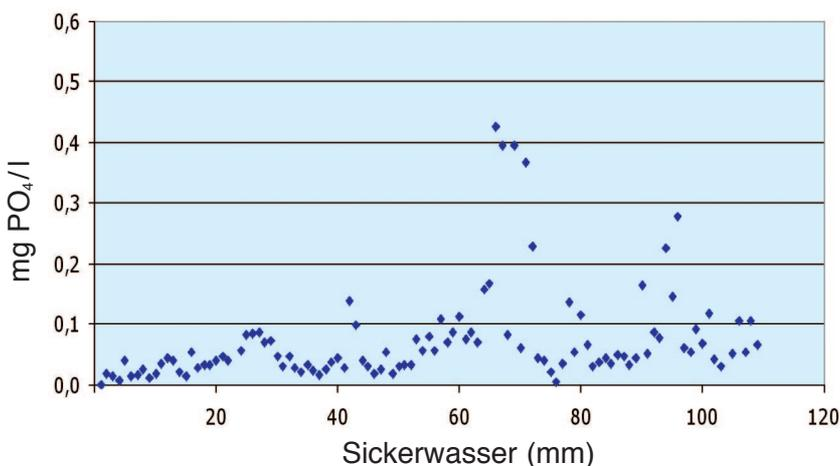
**Höhere Phosphatkonzentrationen im Sickerwasser treten in größeren Tiefen erst bei höheren Sickerwassermengen auf, also wenn die Versickerung rasch erfolgt. (Sickerwassergewinnung in 1,5 m Tiefe).**
