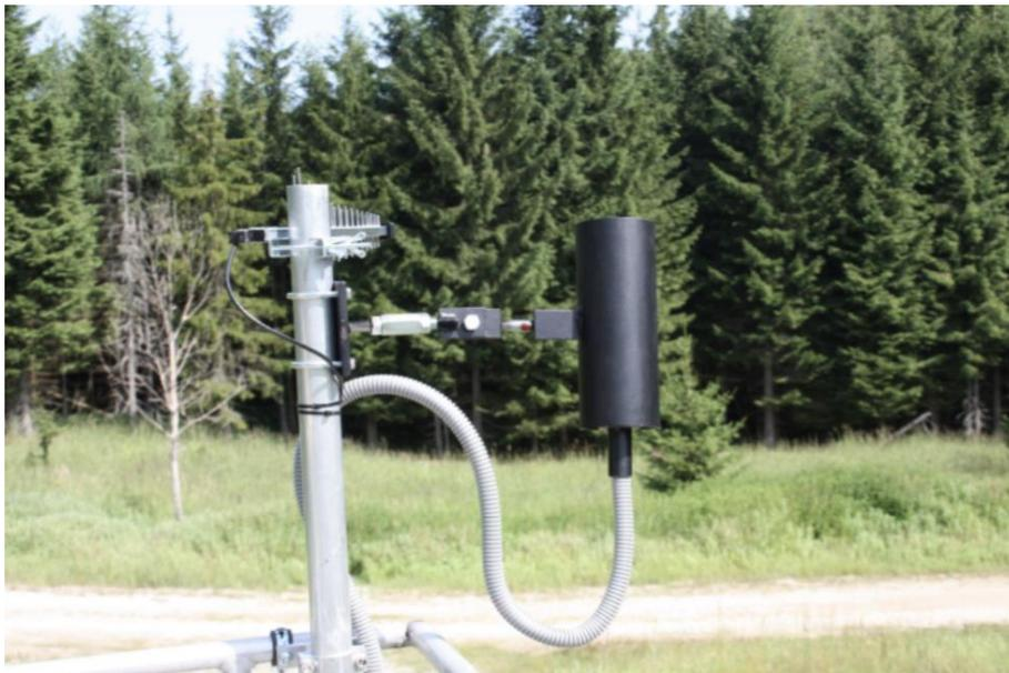
**Abbildung 1** - Foto der Messstation Zöbelboden. Der schwarze Zylinder ist die wetterfeste Behausung.
