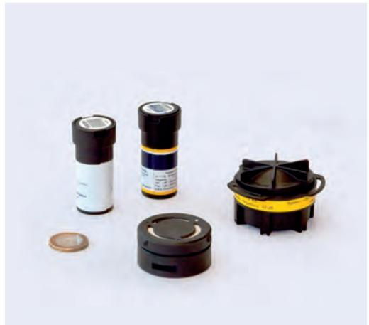
*Passive Messgeräte zur Bestimmung der Radonkonzentration*
