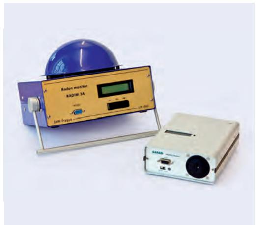
*Aktive Messgeräte für die Überprüfung der Wirksamkeit von Sanierungsmaßnahmen*
