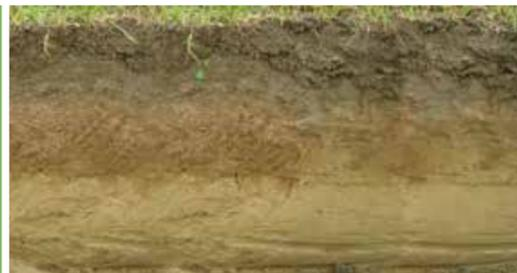
Die Abtragung des Oberbodens (ca. 25 cm Tiefe), Unterbodens (ca. 25-60 cm Tiefe) und Untergrundes sollte schichtweise erfolgen. Der abgetragene Boden sollte idealerweise umgehend wieder eingebaut werden. Bei längerer Zwischenlagerung des Bodenaushubmaterials ist eine getrennte Lagerung an einer wasserdurchlässigen und trockenen Stelle wichtig. Nach dem Ende der Bautätigkeit muss der Boden entsprechend der ursprünglichen Schichtung wieder eingebaut werden.
