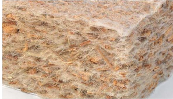
Abbildung 6-14: Rohrkolbenschilfmatte; [Naporo Klima Dämmstoff GmbH, 2012]
