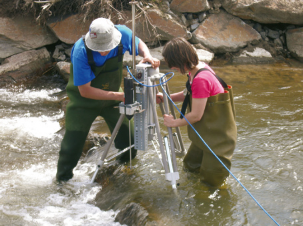
Abb. 121: Messung der Strömungsgeschwindigkeit in den Korridoren (Kapitel Fischökologie – Freilandmessungen)
