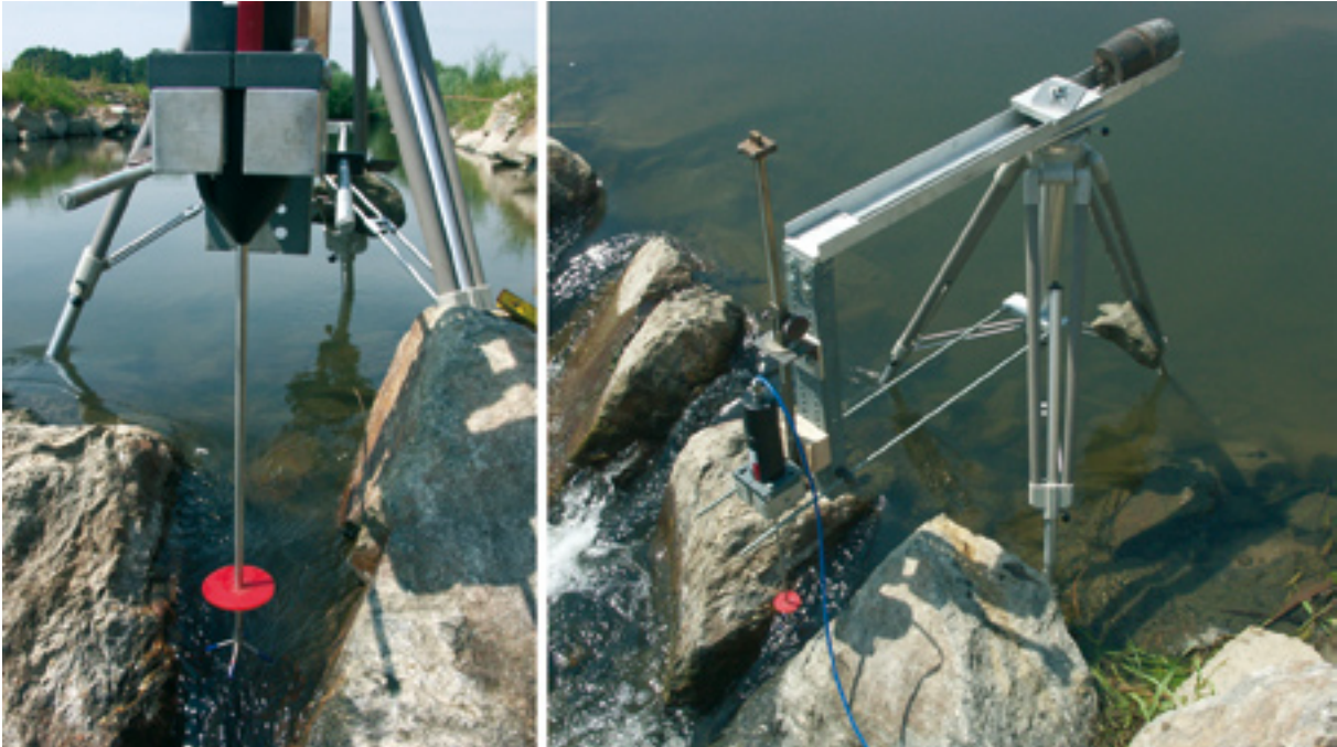
Abb. 202: Vectrino-Sonde zur 3d-Geschwindigkeitsmessung und Stativ
