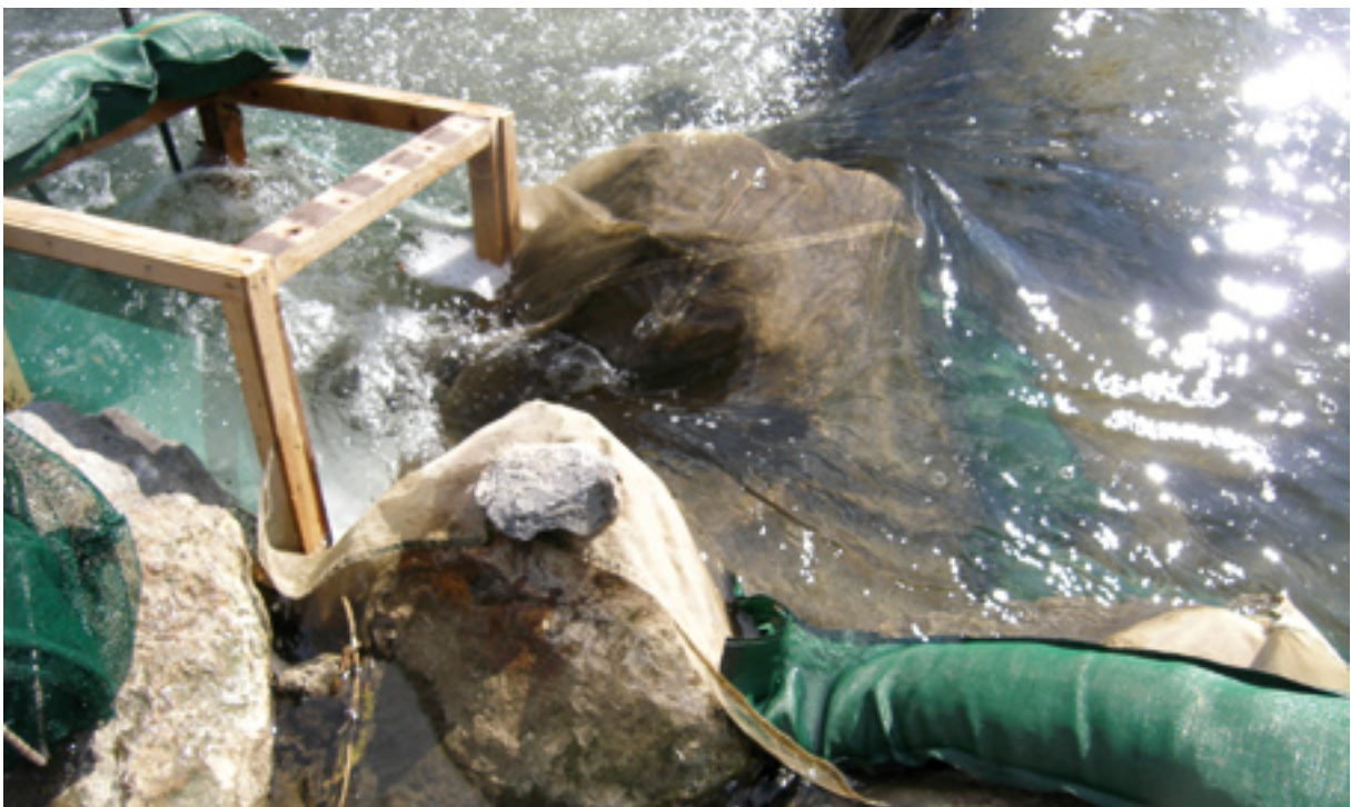
Abb. 235: Kastenreuse mit Planktonnetzschürze am Wanderkorridor
