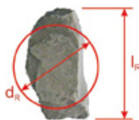
Abb. 12: Definitionsskizze charakteristische Steinlängen
