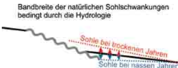
Abb. 21: Erforderliche Rampenlänge aufgrund natürlicher Sohlenschwankungen beim dynamischen Sohlgleichgewicht
