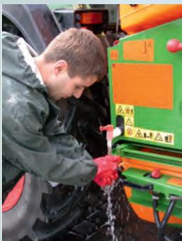
Das Land Oberösterreich empfiehlt den Aufbau von Handwasch- und Reinwasserbehältern für die Reinigung der Pflanzenschutzgeräte am Feld und den Einbau von kontinuierlichen Innenreinigungssystemen bei schon in Gebrauch befindlichen Pflanzenschutzgeräten. Dadurch können mögliche Verunreinigungen für Folgekulturen und chemische Reaktionen im Tank vermieden werden.
