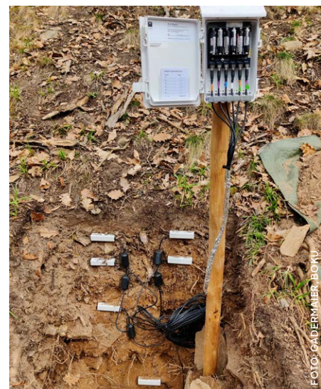
Bei der Einrichtung der Dauerversuchsflächen. Bodenprofil mit Bodenfeuchtesensoren und Datenlogger.
