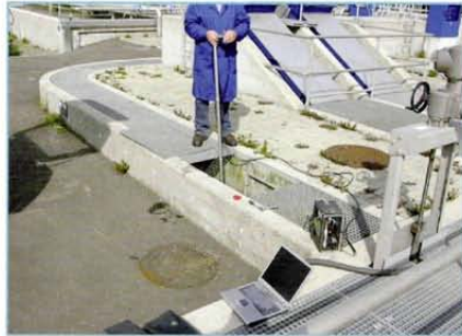
Abb 4: Prüfung des Durchflusses für die Beschickung der Nachklärbecken mit Doppler Ultraschallsonde
