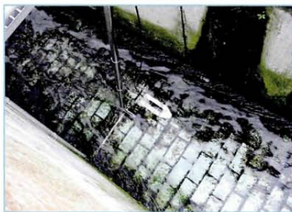
Abb 6: Durchflussmessung für den Gesamtablauf mit Doppler Ultraschall Prinzip
