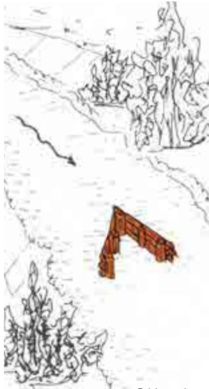
Belebungs-element als Holzpiloten mit Querhölzern (Rundlinge) – in V-Form mit der Spitze bachaufwärts gerichtet
