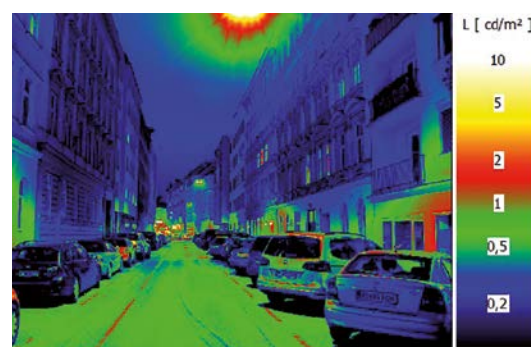
Abb. 27: nach der Umrüstung auf eine gezielte LED-Beleuchtung
