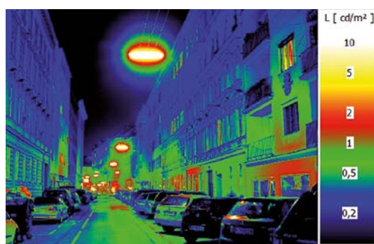
Abb. 26: bisherige Beleuchtung einer Gasse in Wien mit Leuchtstofflampen
