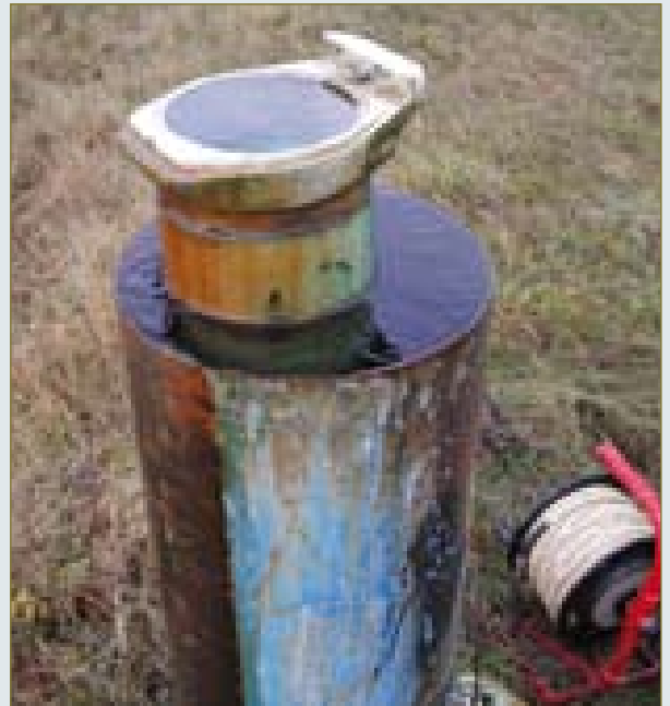
Abb. 4-4: Grundwassersonde im Kontaminationsbereich
