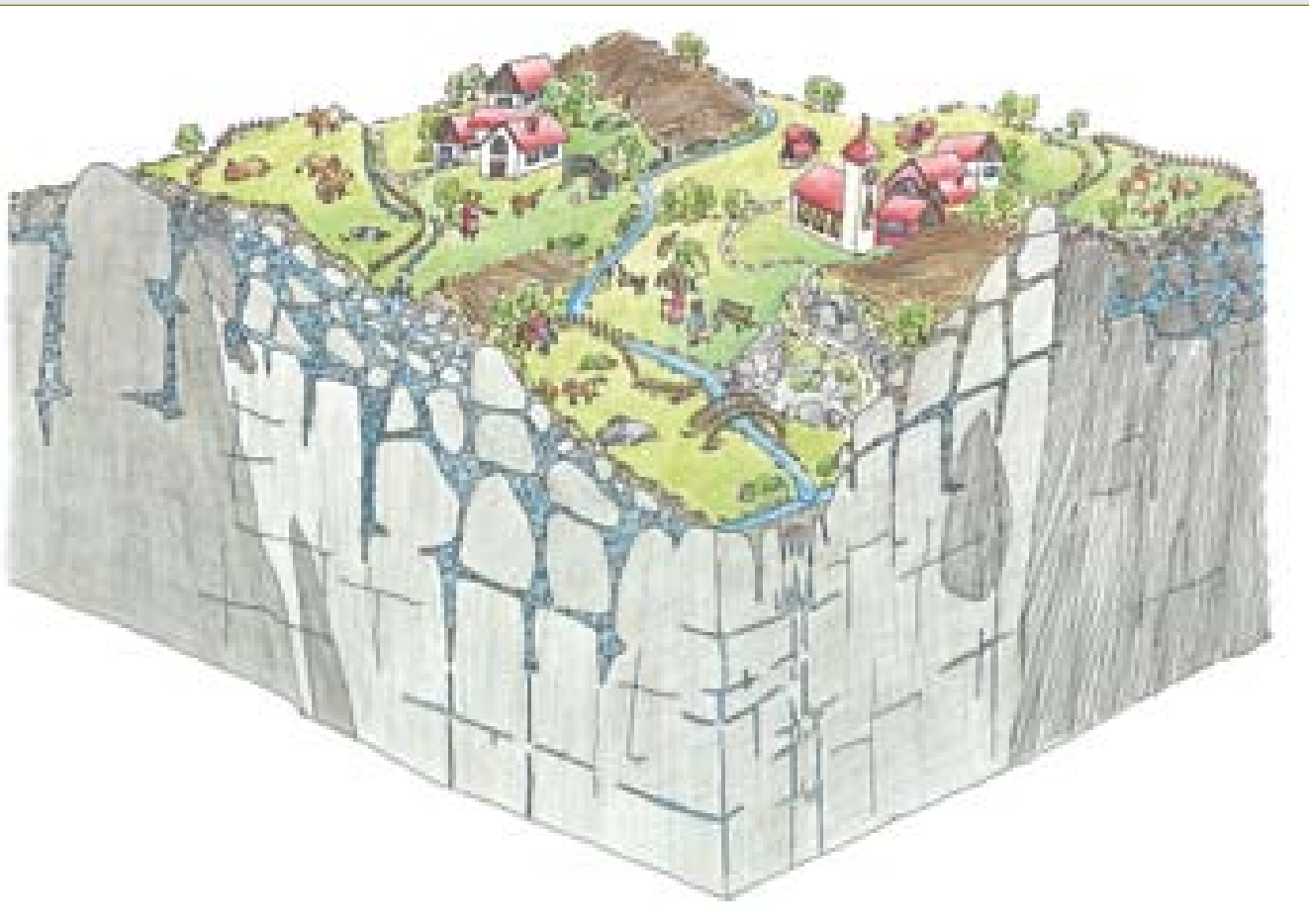
Abb. 2-5: Schematische Darstellung von Kluffundwassern
