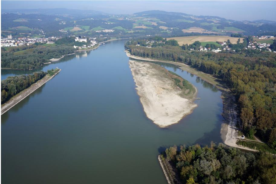
**Abbildung 1-18: Neuhergestelltes Insel-Nebenarmsystem im Sinne des Leitbildes der furkierenden Donau im Eferdinger Becken**
