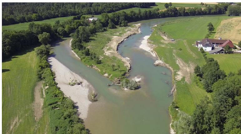
**Abbildung 1-20: Eine Aufweitung mit Nebenarm an der Ybbs, die unmittelbar stromauf der Stauwurzel eines Kraftwerkes liegt. Bei einem höheren Stauziel wäre eine solche Maßnahme nicht umsetzbar (LIFE+ Projekt Mostviertel-Wachau).**
