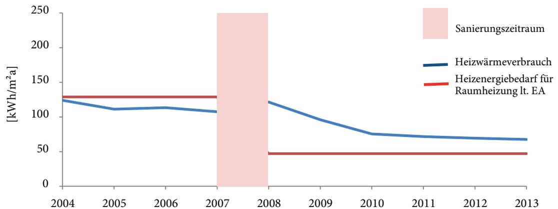
**Abbildung 12:** Spezifischer Heizwärmeverbrauch und spezifischer Heizenergiebedarf für Raumheizung je m<sup>2</sup> Bruttogeschossfläche – Wohnanlage D
