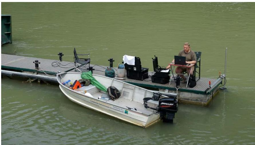
Abbildung 4: Stationär auf einem Steg aufgebautes DIDSON-Gerät.
