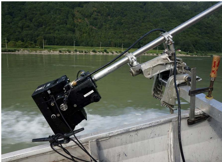
Abbildung 5: Mittels Querbalken auf einem Aluboot montierte hydroakustische Kamera.
