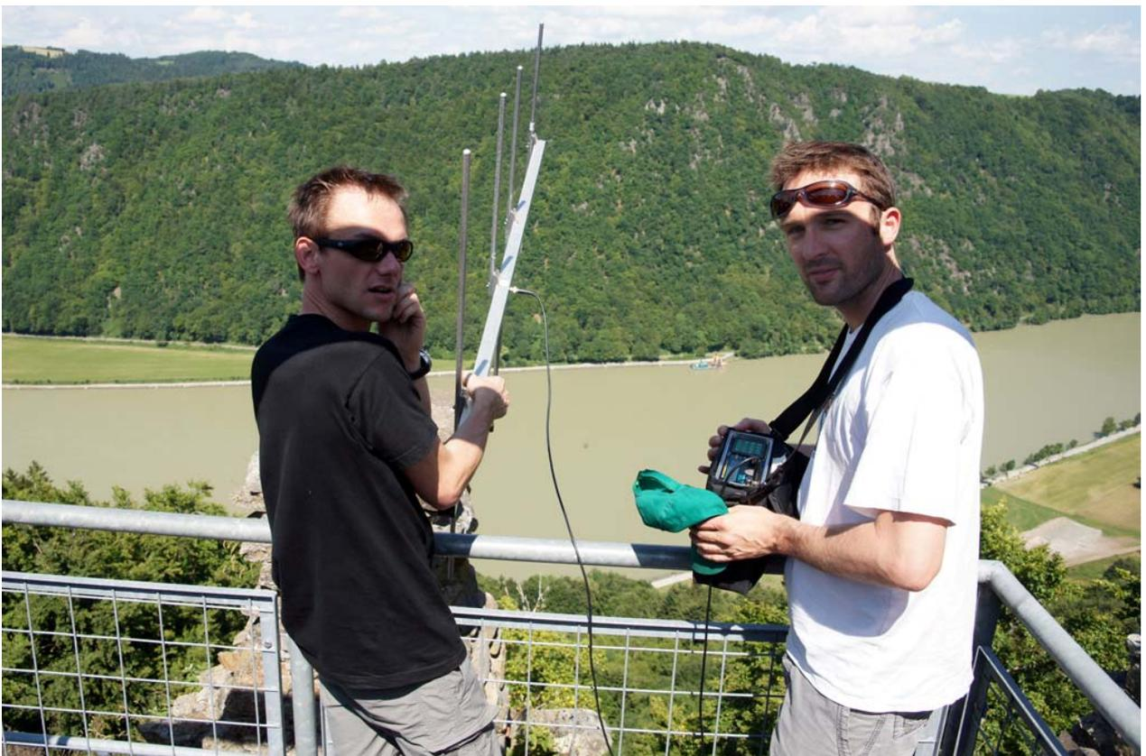
Abbildung 12: Test der Reichweite der Radiotelemetrie an einem potentiellen Standort für eine Fixstation (Burgruine Haichenbach).
