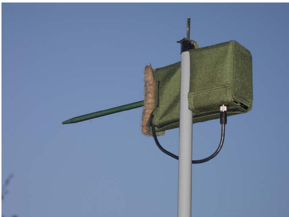
**Abb. 2** Automatische Registriereinheit („batcorder“, ecoObs, Nürnberg)
