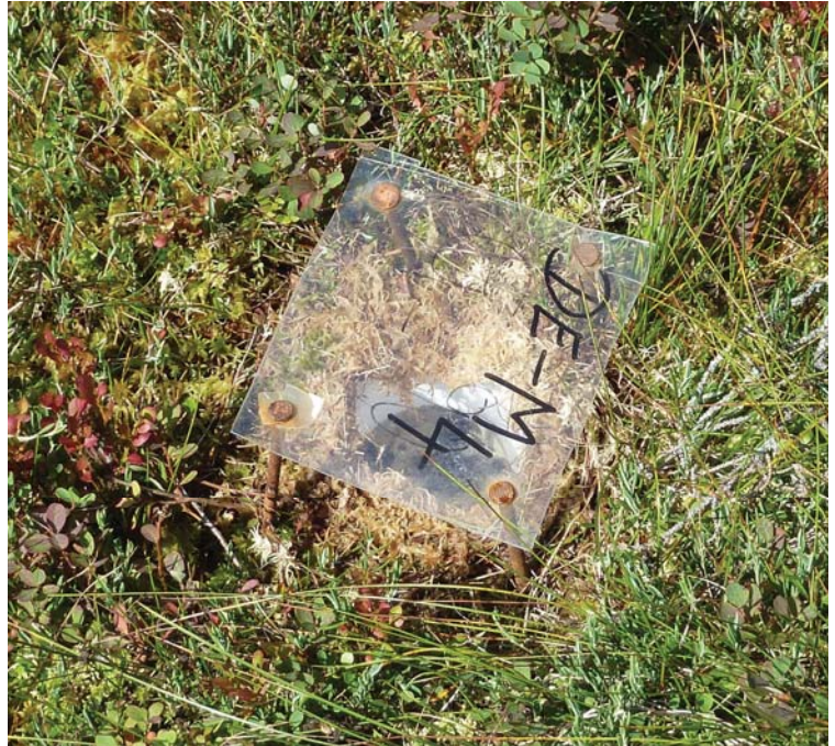
Abb. 50: Barberfalle mit Plexiglasdach (Foto: L. Schlosser)
