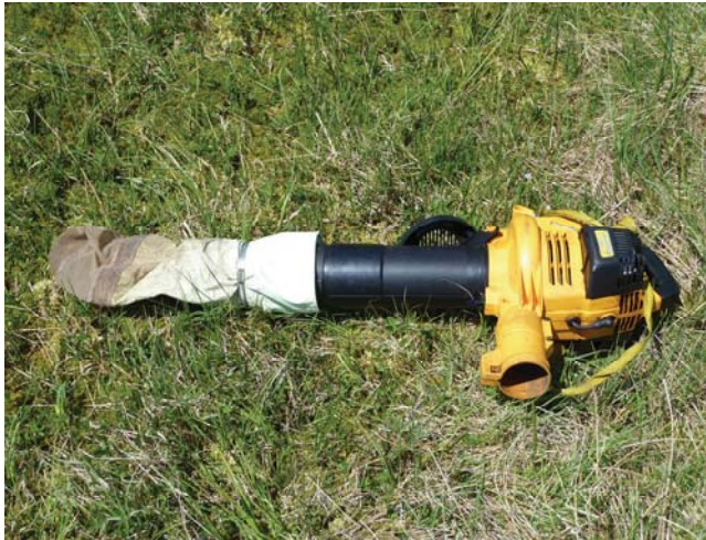
Abb. 51: Modifizierter Laubsauger mit ausgestülptem Gazebeutel (Foto: L. Schlosser)
