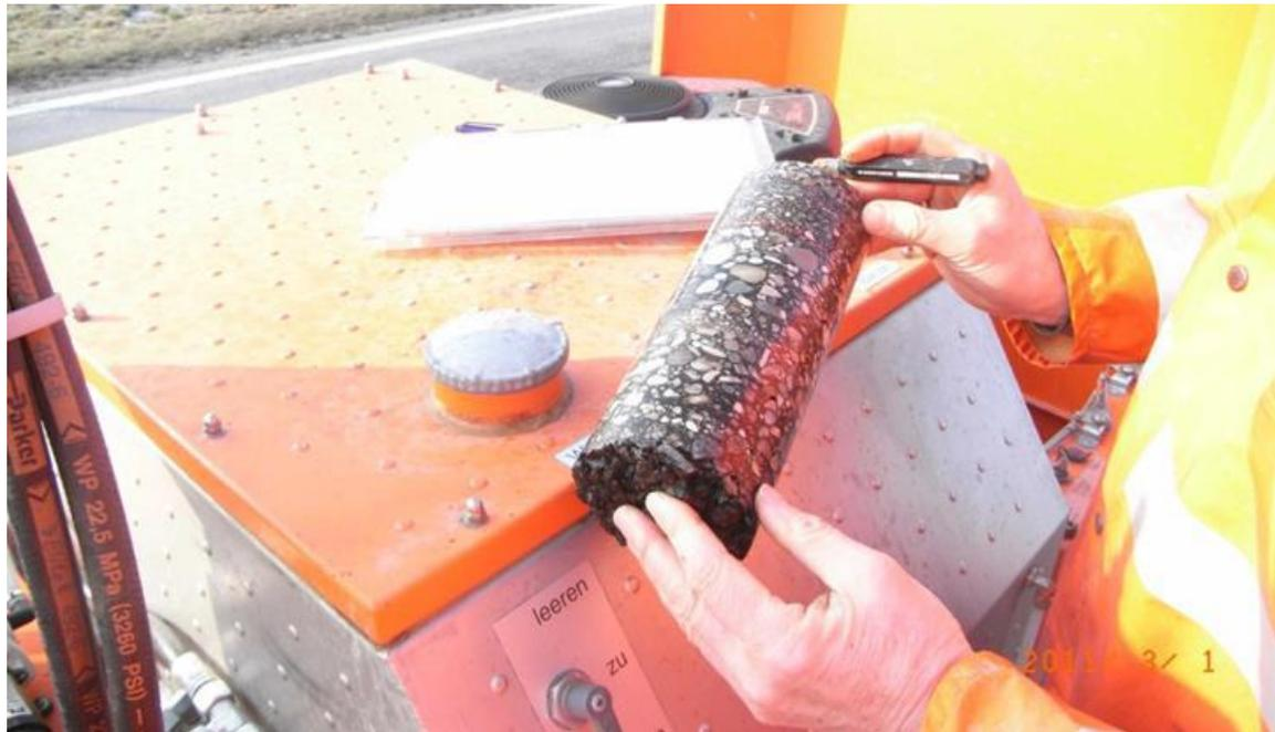
Abbildung 3: Bohrkernentnahme für weitere Analysen durch die BPS (Quelle:Land OÖ)
