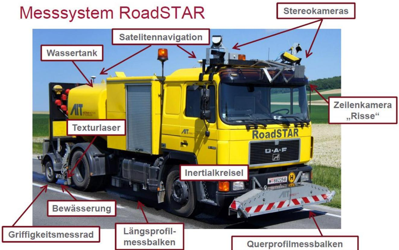
Abbildung 2: Messsystem RoadSTAR des AIT (Quelle AIT)
