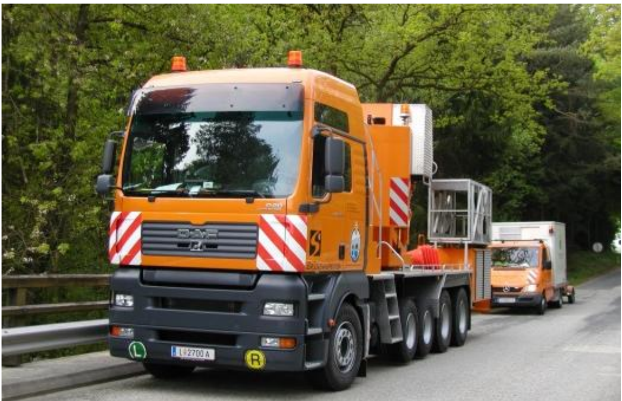
Abbildung 4: Brückeninspektionsgerät des Landes OÖ Quelle: Land OÖ
