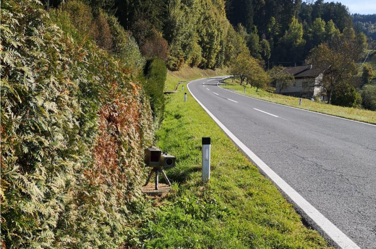
Abbildung 13: Neue, mobile Messgeräte zur Geschwindigkeitskontrolle im Einsatz Quelle: Eso-GmbH
