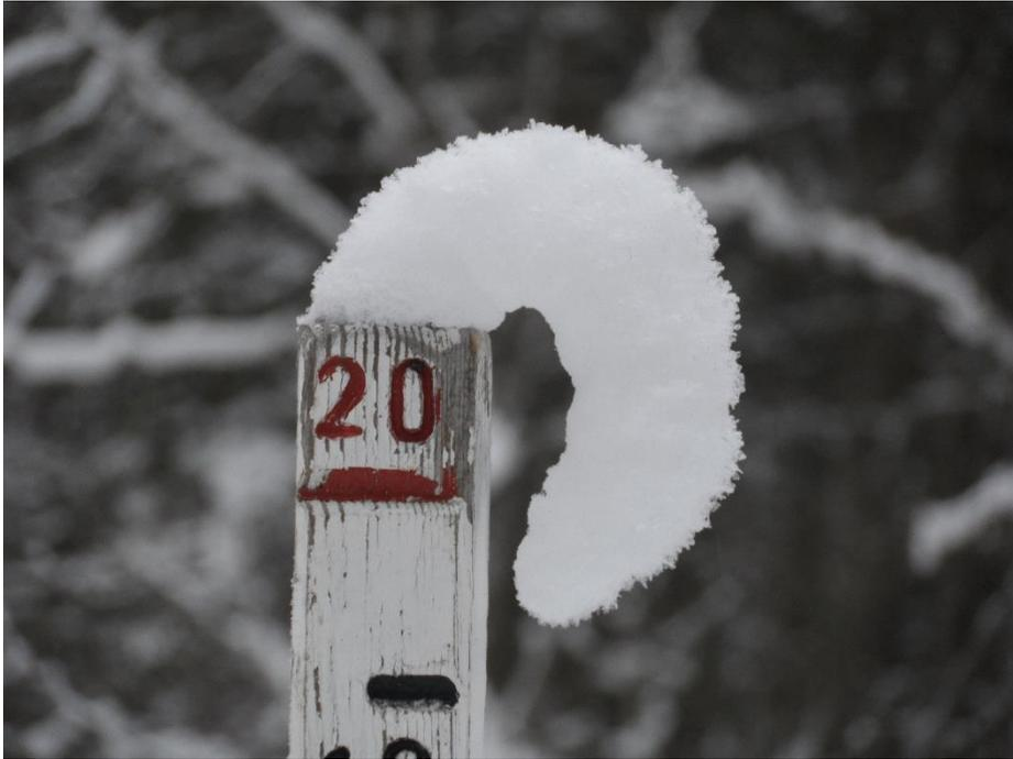
2 Meter Schneemesslatte zur Kontrolle der automatischen Messung
