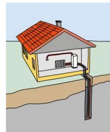
Tiefe von bis zu 100 m abgeteuft. In die Bohrlöcher wird ein Rohrsystem eingebracht, anschließend werden die Bohrlöcher ver-
