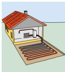
Das im Rohrsystem zirkulierende Arbeitsmittel entzieht dem Erdreich gespeicherte Sonnenenergie.
