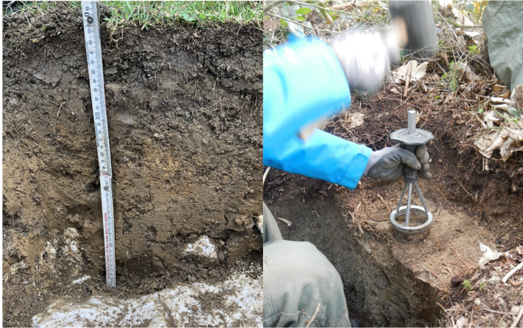
Abbildung 4-5: Links Bodenprofil, flachgründiger Braunlehm auf Kalk, horizontweise Bodenansprache; rechts: Stechzylinder-Probenwerbung für Laboranalysen
