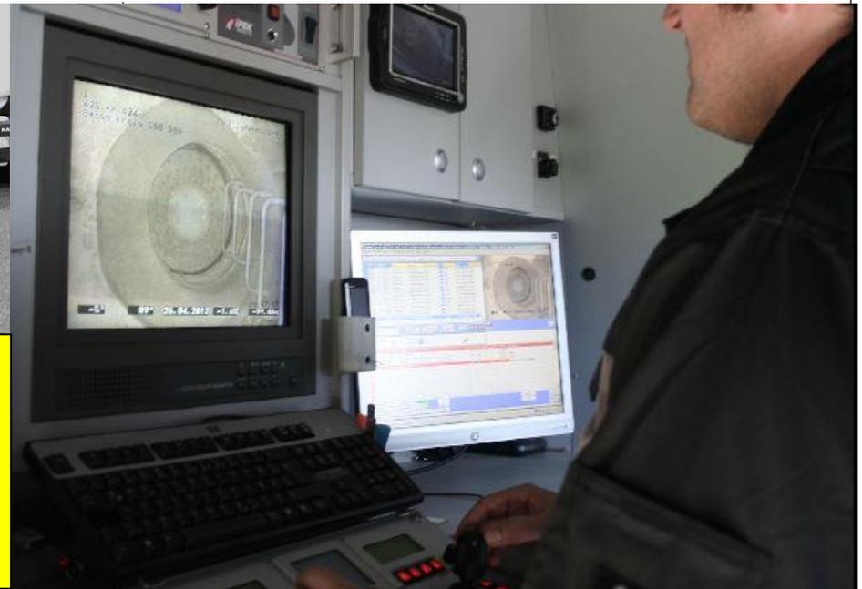
Die Erhebung von "Kanalzuständen" (z.B. Rissen) ergibt die **Zustandsklasse**
