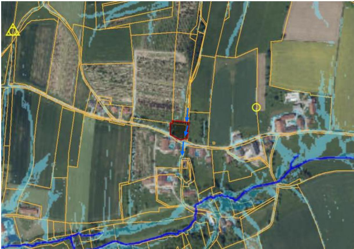
Der Hangwasserabfluss trifft im nordöstlichen Bereich auf die Parzelle. Der Abfluss erfolgt entlang der östlichen Grundstücksgrenze in einer natürlichen Geländemulde. Das Hangwasser läuft im südwestlichen Bereich der Parzelle der unterhalb des Grundstückes liegenden Straße zu. Der Abflussweg ist im Einreichplan schematisch dargestellt.
