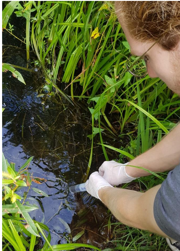
Abb. 3: eDNA Probenahme: Wasser wird mittels Spritze durch einen Filter gepresst, © H. Sattmann
