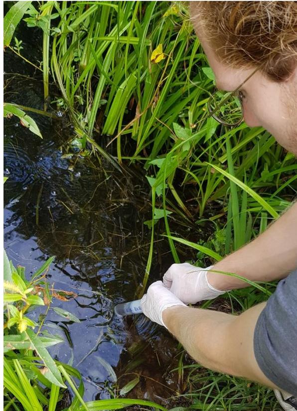
**Abb. 3:** eDNA-Probennahme: Wasser wird mittels Spritze durch einen Filter gepresst. © H. Sattmann
