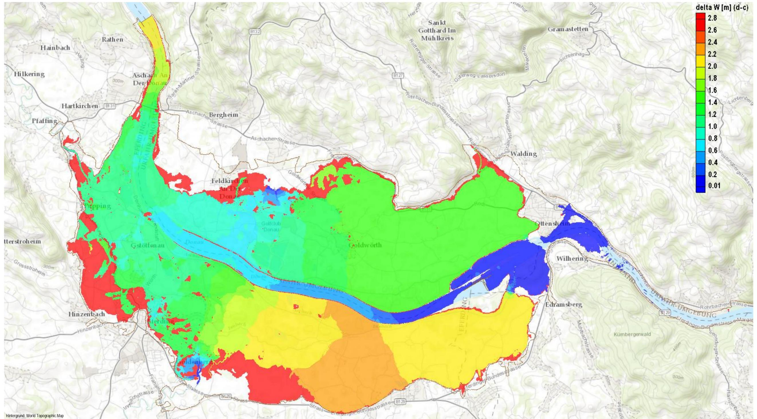
Hinweis: Die roten Bereiche markieren jene Gebiete, die beim Szenario „EXTREM-Verlandung“ gegenüber dem Szenario „nach HW2013“ zusätzlich überflutet werden (diese Flächen stehen daher in keinem Zusammenhang mit Wasserspiegeldifferenzen im Ausmaß von mehr als 2,8 m, welche - sofern sie auftreten würden - gem. der obigen Legende ebenfalls rot dargestellt wären).
