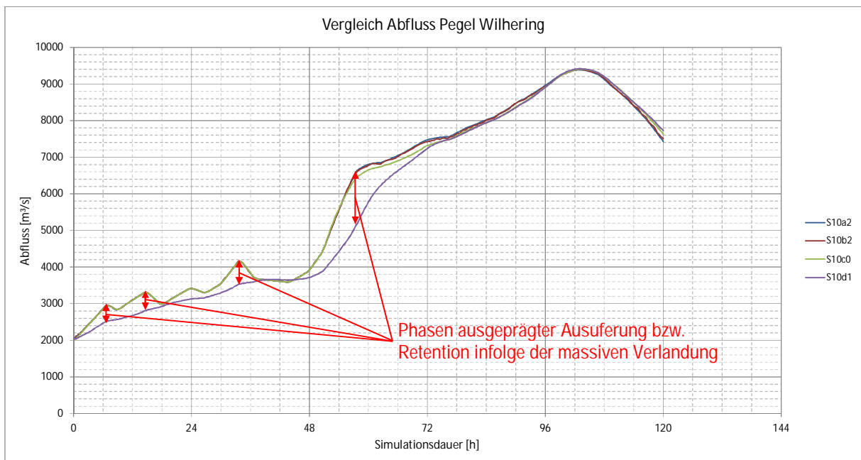
Abb. 4.4 Abfluss beim Pegel Wilhering bei unterschiedlichen Verlandungszuständen
