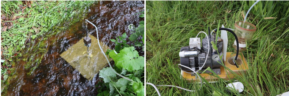
Abbildung 17: Gerätschaften zur Entnahme von Porenwasser (links ... längenverstellbarer Kanüle mit Abdichtungsplatte; rechts ... Pumpe und integrierter Filter).
