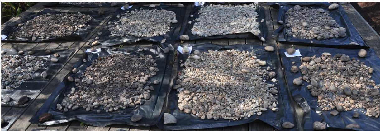
Abb. 53 Trocknung der Proben zur anschließenden Siebung.
