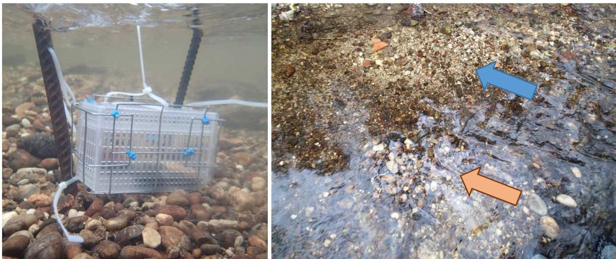
Abb. 70 Links: Verankerung und Drahtkorb mit befestigter WV-Box als Referenz in der freien Welle.
