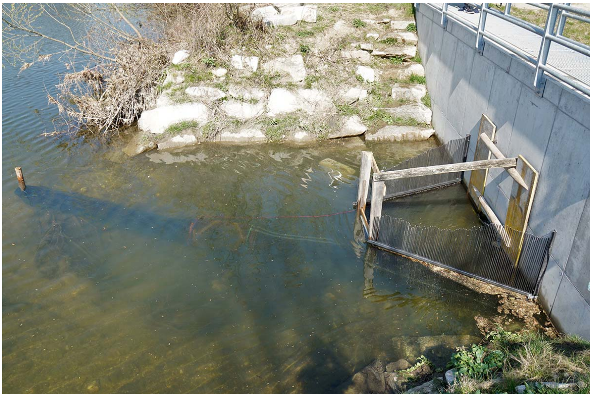
Abbildung 17: Ausstiegsreuse im Oberwasser der untersuchten FAH, bestehend aus einer Absperrung aus zwei Metallrechen und dem Reusensack.
