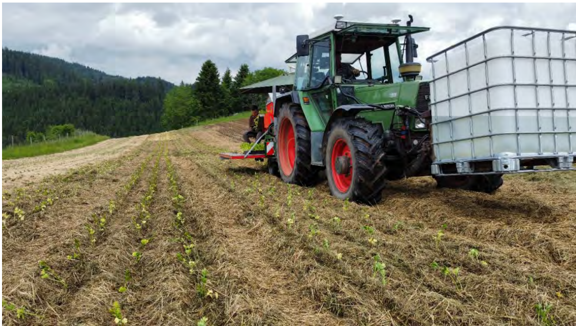
Mulchpflanzmaschine beim Setzen von Gemüse (© Elisabeth Hartinger).
