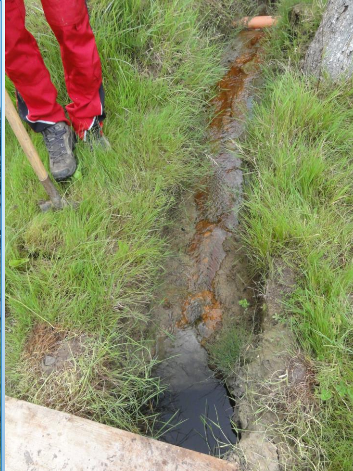
Sondierungen, Abflussmessungen und Druckmessungen zur Kartierung der Verwilderungszone
