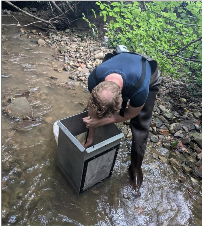
Abb. 7 Makrozoobenthos-Probenahme im Sulzbach mit Hilfe eines Kastensamplers.
