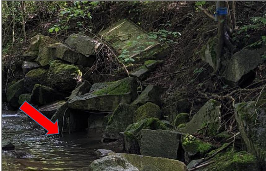
Abb. 6 *Dauermesssonde beim Standort „Acker 2“ zur permanenten Messung von elektrischer Leitfähigkeit, Wasserstand und Temperatur.*
