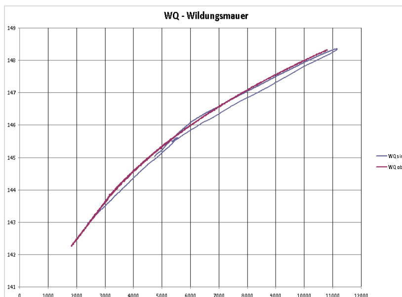
Abb. 6.3 Pegel Wildungsmauer: W-Q-Beziehungen direkt aus Simulationsläufen und aus den Messdaten der via donau
