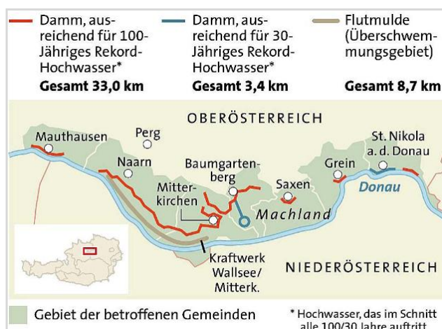
Abb. 6.25 Überblick Machland-Schutzdamm - schematisch
