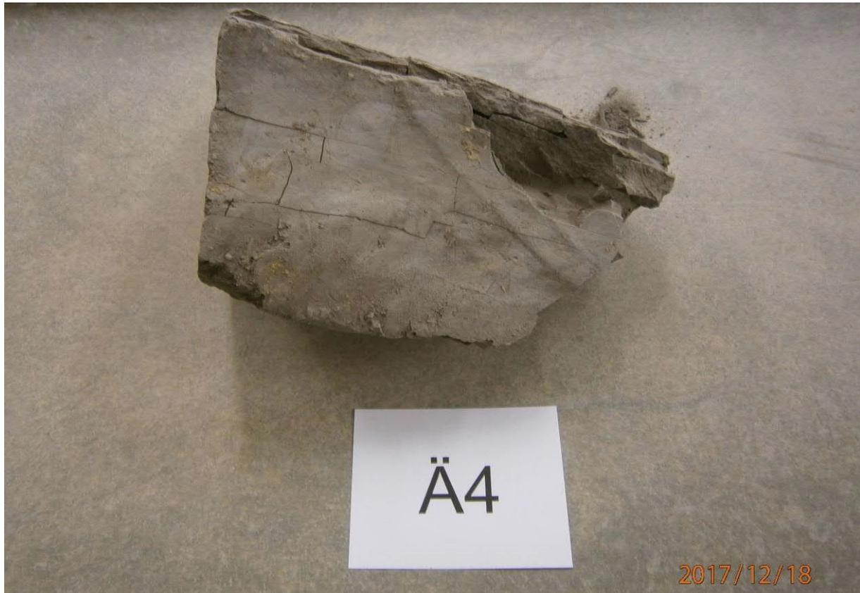
Längere Zeit gelagerte Probe stark ausgetrocknet
