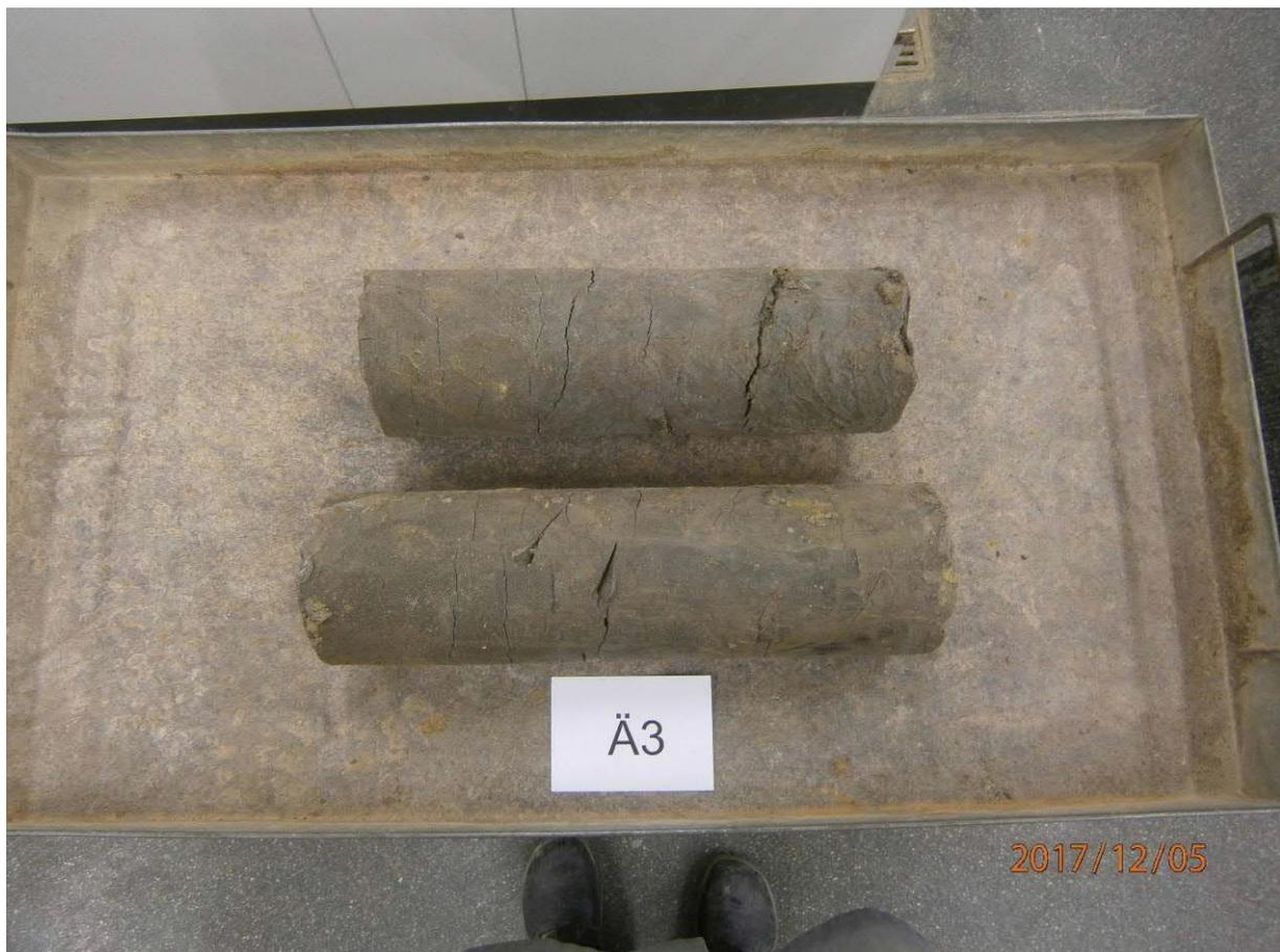
längere Zeit gelagerte Bohrkiste: daher stark ausgetrocknete Probe
