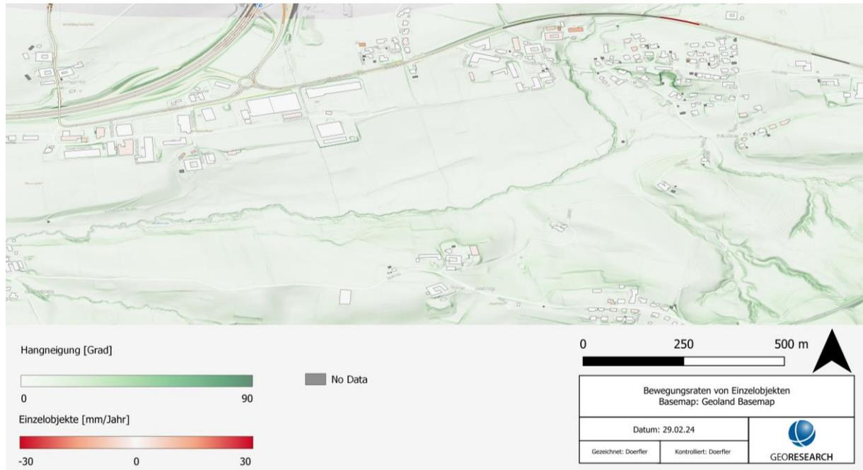
Abbildung 20: Objektbasierte InSAR-Auswertung im Bereich des Gewerbegebiets Radingdorf-Obervisnitz.
