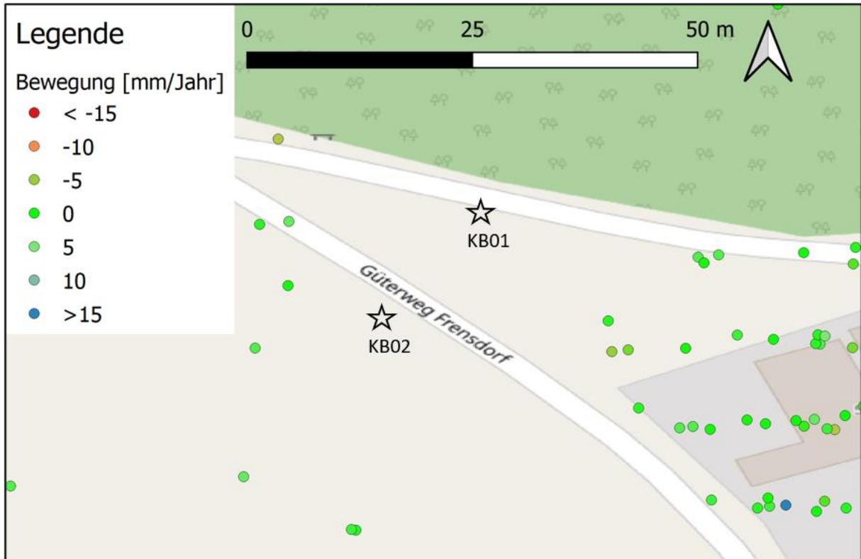
Abbildung 38: Lage der InSAR-Messpunkte im Bereich von KB01 und KB02.
