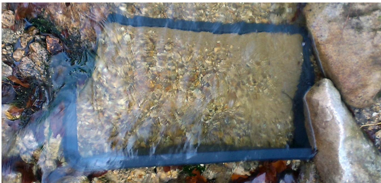
Abbildung 280: Feststoffe in der Geschiebefalle 4 am 16.01.2015
