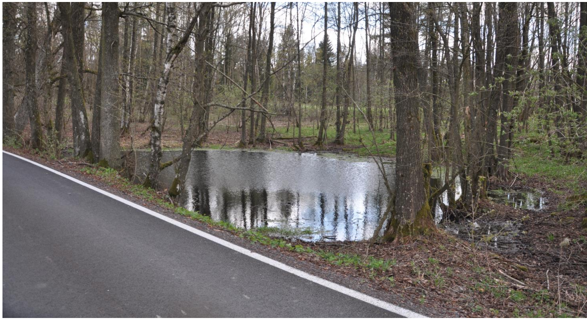
Kleiner Landschaftsteich hält Wasser aus einem Graben zurück, Feinsedimente werden abgesetzt (Maltsch-Gebiet, CZ) (© Sarah Höfler).
