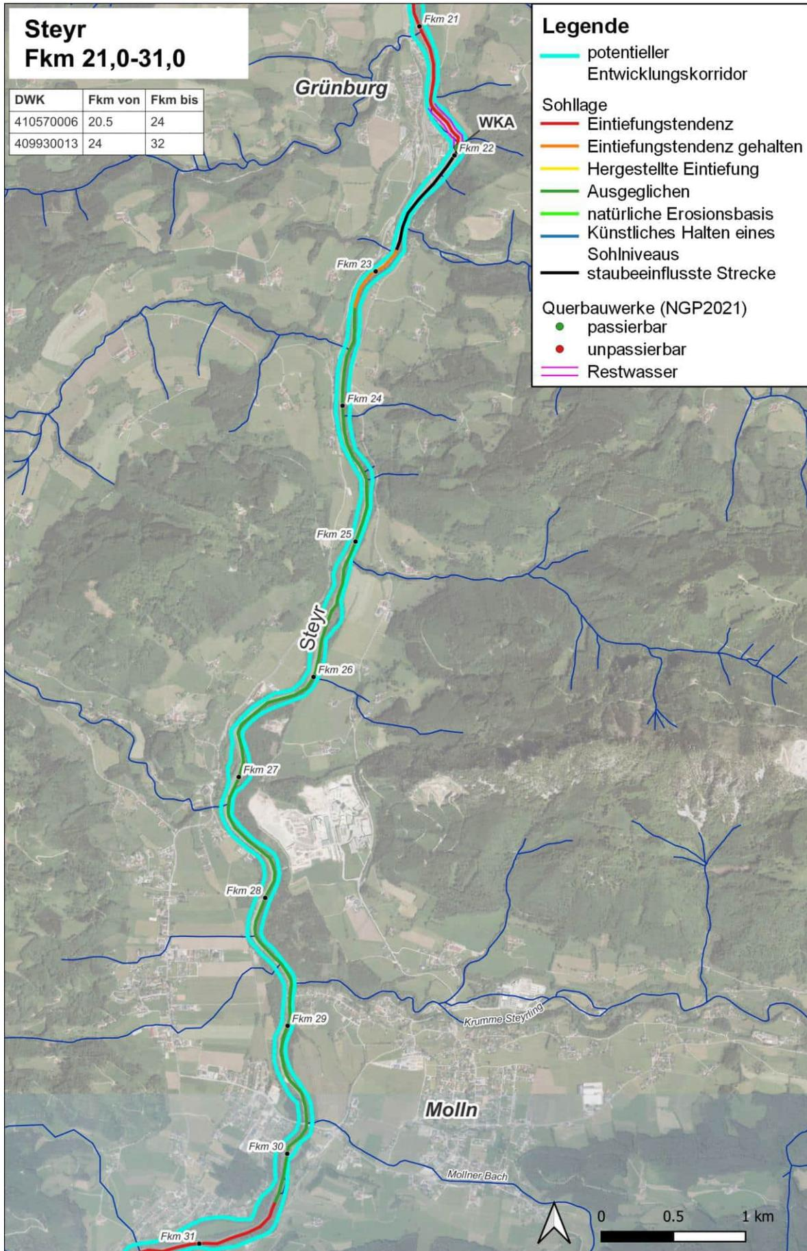
Abbildung 153: Steyr zw. Fkm 21,0-31,0 Maßnahmenpotential, Sohlage und Querbauwerke.
