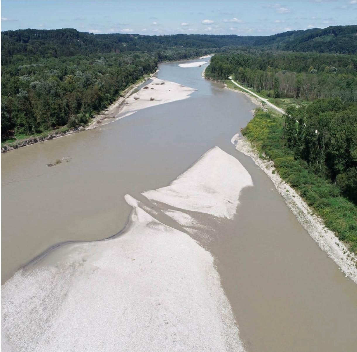
Abbildung 42: Salzach flussab Tittmoning: Nach bereichsweisem Rückbau der Ufersicherung hat sich die zuvor stark begradigte Salzach innerhalb von 3 bettbildenden Hochwässern deutlich an der ursprünglichen Flusstyp angenähert. Die Entwicklung ging dabei so rasch, dass der aktuell verfügbare Korridor auf oberösterreichischer Seite (im Bild rechts) aufgebraucht war und das Ufer erneut gesichert werden musste.
