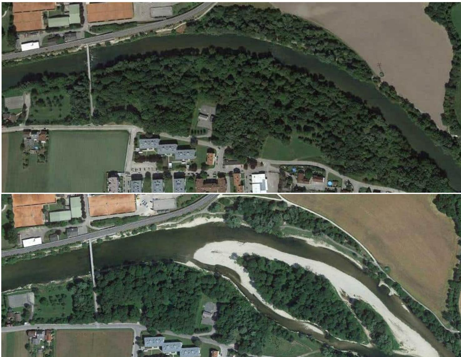
Abbildung 48: Beispiel für eine mittlere bis große Maßnahme an der Ybbs vor und nach Umsetzung. Vor Umsetzung befanden sich im Bereich der Brücke und in der Mitte der Aufweitung zwei kleine Sohlschwellen. Deren Spiegeldifferenz wird durch die Aufweitung mit Nebenarm nun vollständig auf natürlichem Wege überwunden.
