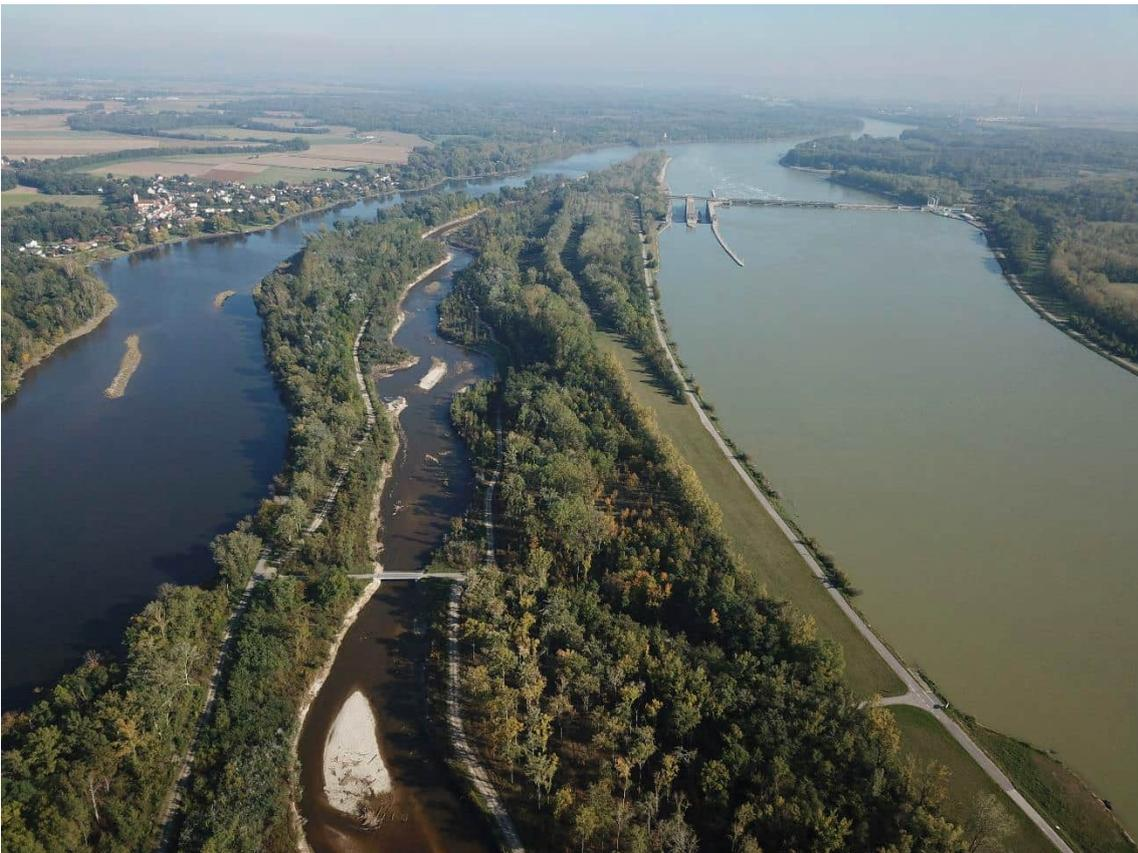
Abbildung 51: Beispiel Umgehungsarm Donaukraftwerk Altenwörth.
