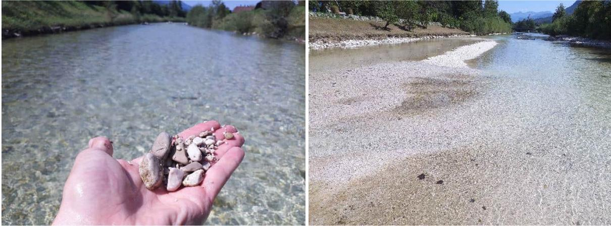
Abbildung 114: Oben links= monotone Kieskornverteilung bei Fkm 1,3. Oben rechts= Substratvergrößerung bei Fkm 4,6. Unten links= hoher Feinkiesanteil im Lückenraum der vergrößerten Deckschicht bei Fkm 2,4. Unten rechts= monotone Kieskornverteilung in Restwasserstrecke bei Fkm 8,0.
