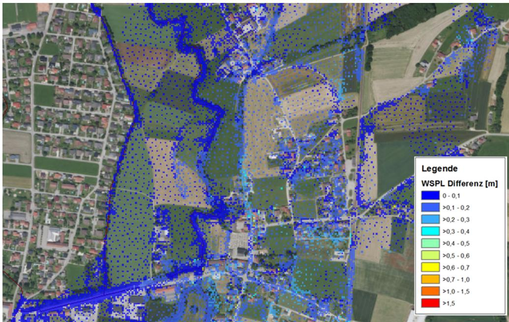
Abbildung 11: Wasserspiegeldifferenz (WSPL Differenz) in m zwischen HQ300 und HQ100 in Helpfau-Uttendorf (Mattig)
