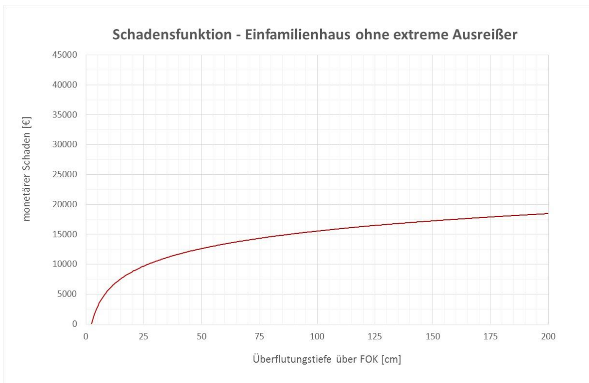
Abbildung 45 Schadensfunktion für Einfamilienhäuser ohne extreme Ausreißer
