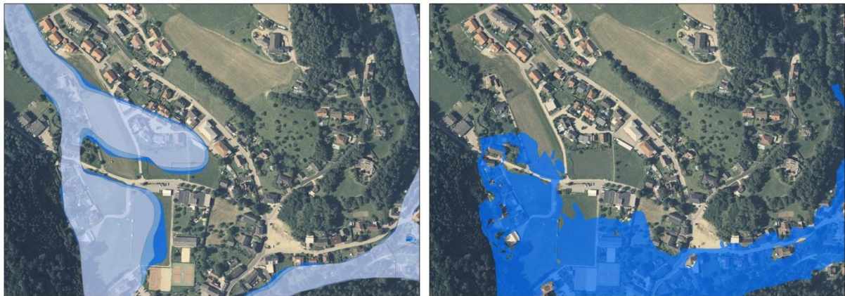
Abbildung 13: Bewertungsgrundlagen der Gefährdung links: HORA, rechts HQ 300 2D Modell (Nachtnebel et al., 2010)
