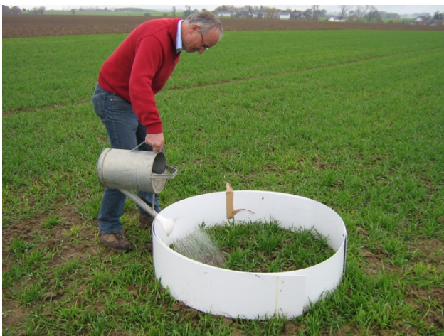
Abb. 3-1: Ausbringen der Bromidlösung
