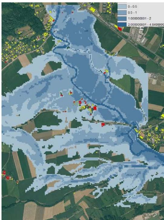
**Abb. 3.11** Simulierte maximale Wassertiefen für das Hochwasserereignis 2002 unter Vernachlässigung des Donaeinflusses
