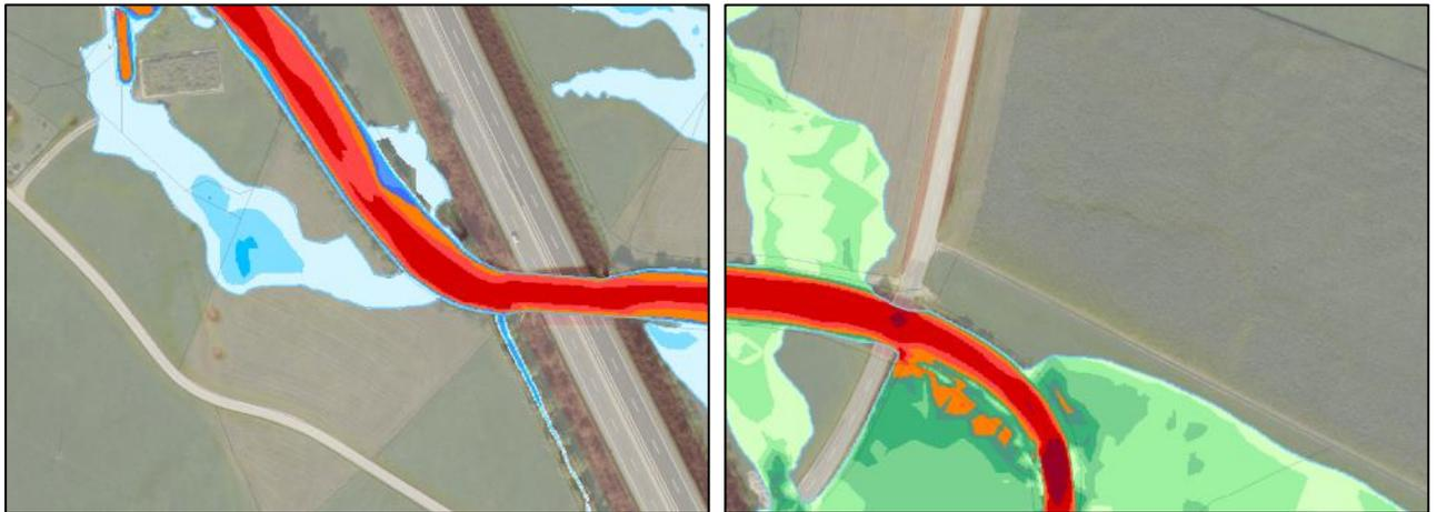
Abbildung 5-5: Berechnete Wassertiefen und Fließgeschwindigkeiten
