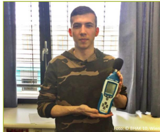
**Ein Schalldruckpegelmessgerät im Einsatz**
