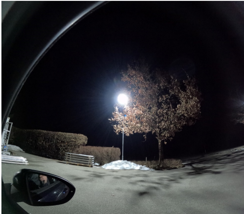
Abbildung 16 – Beleuchtungssituation am NTA New Technology Anlagenbau Parkplatz. Kaltweiße LED beleuchtet nicht nur den Parkplatz, sondern strahlt auch mitten in einen davorstehenden Baum.
