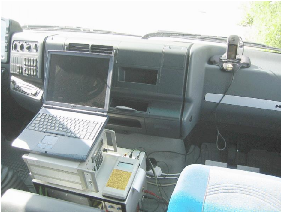
Abbildung 11: GPS-Einheit im Fahrzeug zur Bestimmung der Fahrmuster
